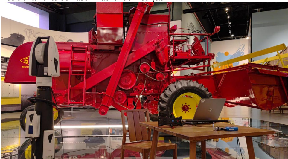
Figura 7 - Posicionamento do Laser Tracker de medição
