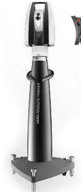
Figura 6 - Equipamento de medição Laser Tracker
