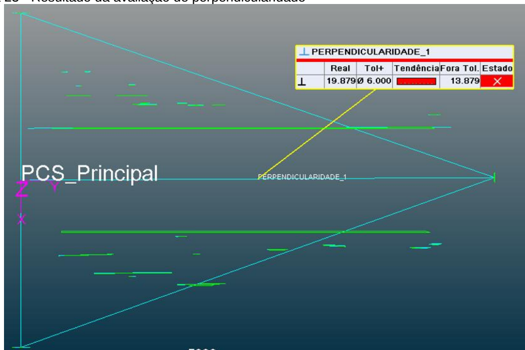
Figura 23 - Resultado da avaliação de perpendicularidade
