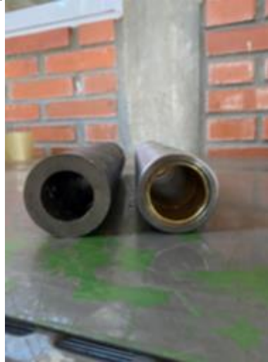
Figura 10 – Bucha articulada, comparação antes e depois de acabado
