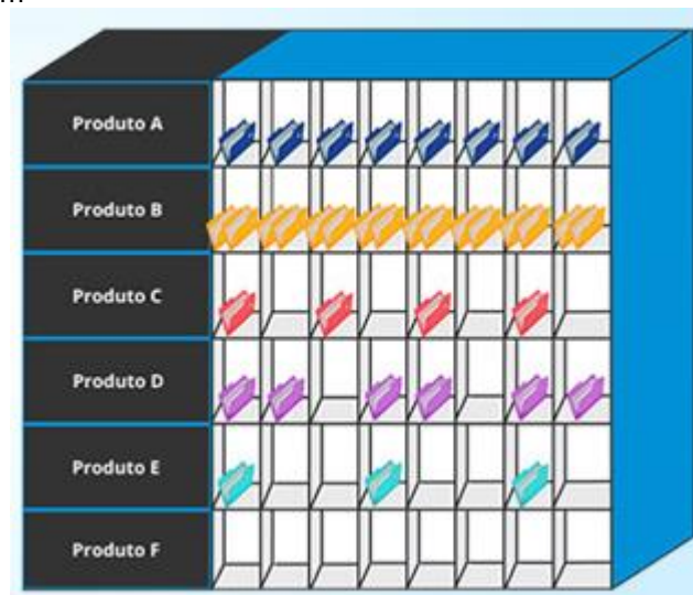
Figura 6 – Esquema da caixa Heijunka , ferramenta visual do Sistema Toyota de Produção ( Lean ) utilizada para nivelar e sequenciar a produção ( Heijunka ), distribuindo uniformemente a variedade de produtos ao longo do tem
