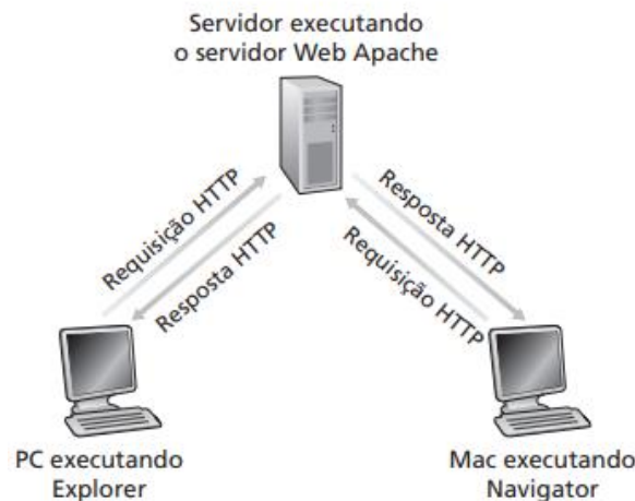
Figura 3 - Troca de requisições entre aplicações e servidor via HTTP
