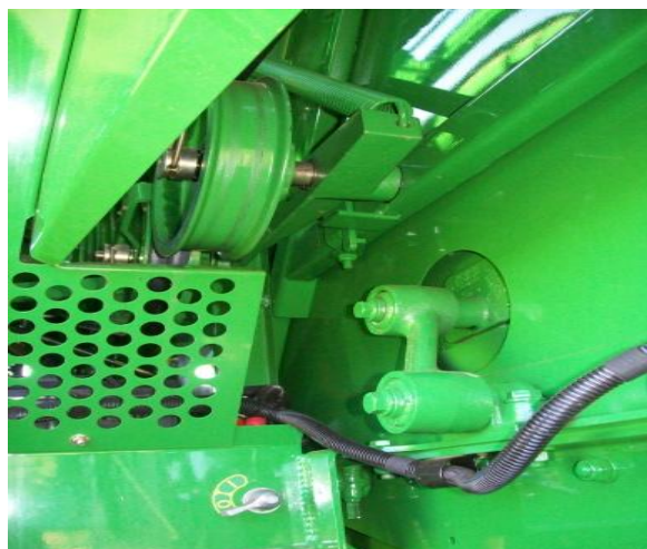
Figura 3 – Proteção cobre parcialmente partes em movimento. Fonte: Os autores (2013).
