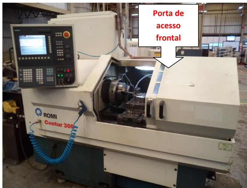
Figura 2 – Parte frontal do torno CNC 19
