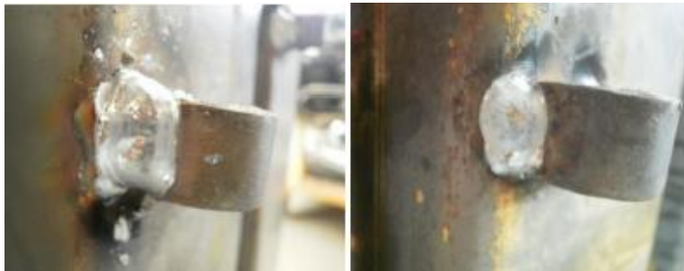
Figura 4 – Foto de um Cordão de Solda Antes das Especificações e Depois. Fonte: Autor.
